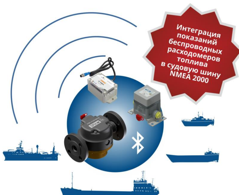
Рисунок 2 — Назначение конвертера данных MasterCAN S7 NMEA
